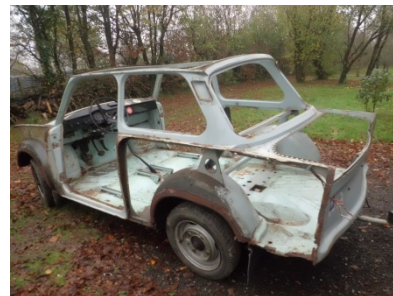
Dénudée, laissant apparaître les taches de rouille
